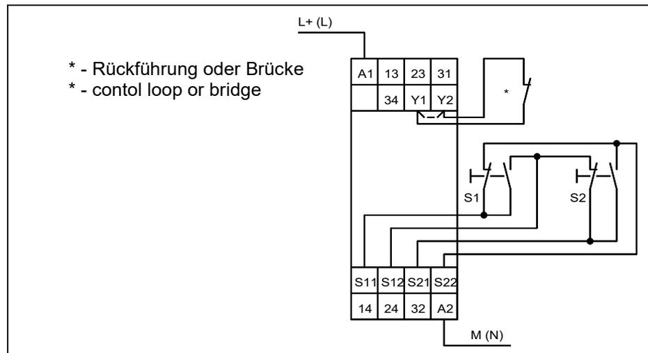
2. Anschluss der Versorgungsspannung
