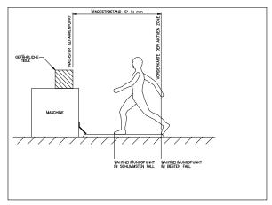
Um den Anfangspunkt der Schaltmatte zu definieren, muß die Reaktionszeit der Maschine/Anlage bekannt sein. Die Gesamtreaktionszeit T eines Systems ist die Zeitspanne vom Moment an, an dem der Fuß einer Person die Matte betritt, bis zum dem Augenblick, an dem der gefährliche Bewegungsablauf beendet ist.
