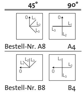
MESSUNG 3-PHASEN-STROMKREIS L<sub>1</sub>-L<sub>2</sub>-L<sub>3</sub> MIT 1 AMPEREMETER UND 3 WANDLERKREISEN OHNE GEMEINSAMEN ANSCHLUSSPUNKT
