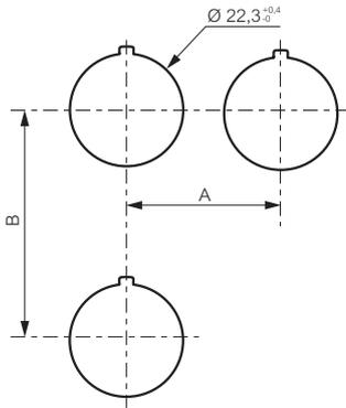
Für Geräte mit Schraubanschluss und Federzugklemme
