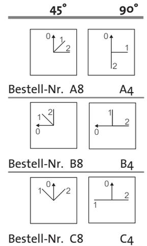
**DREHRICHTUNGUMSCHALTER MIT 0-STELLUNG FÜR 1 DREHZAHL - MOTOR EINPHASIG, MIT KONDENSATOR (4 DRÄHTE)**
