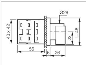
**PR 12 - 16 A (AC21)** **Frontmontage mit Zentralbefestigung 22 mm** **Bestell-Nr.**
