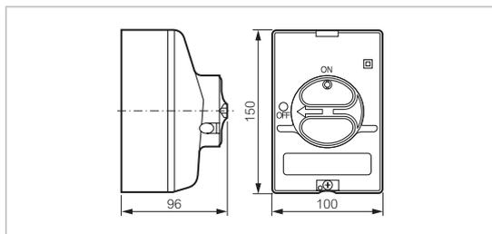
Sicherungstrennschalter, zur Gewährleistung von Unterbrechung und Phasentrennung. IP 2X
